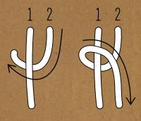
HALF HITCH WRAP LOOP YARN #2 UNDER YARN #1, THEN COME BACK OVER YARN #1 & PULL
